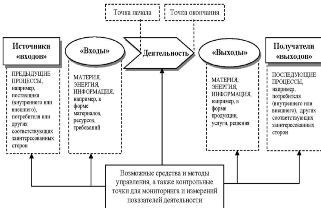
Рис. 1. Схематическое представление элементов единичного процесса
